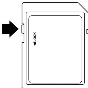
Esta tarjeta SD es válida para ser usada solamente en un vehículo. Nunca la use en otro vehículo. Si la tarjeta SD se usa primero en un vehículo y luego en otro, el sistema de navegación de ambos vehículos podría dejar de funcionar.
